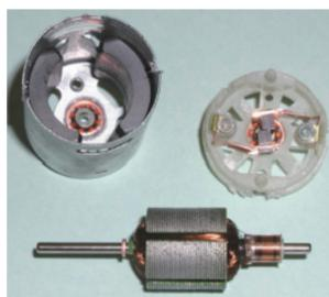
照片 A 分解后的有刷直流电机
